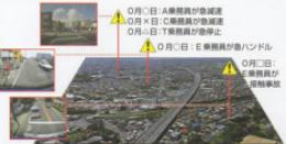
矢崎の解析ソフトはSDカードを挿入するだけでセンサーが感知した衝撃・急加速・急減速などの位置と回数を分析して、専用のナビゲーションMAPを作動化します。これにより運行実態に基づいた危険箇所の把握が可能となり予防安全に活用できます。
